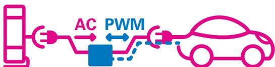
La ricarica in **modo 2** è una ricarica lenta consentita in ambienti privati non accessibili a terzi; utilizza sempre una tensione alternata di 230/400V, con corrente massima di 16A.
