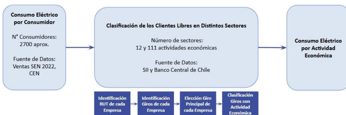
Figura 5. Esquema de determinación del consumo eléctrico por actividad económica.
